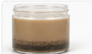
Osad pigmentu — niewłaściwa lepkość lub niekompatybilna dyspersja.
