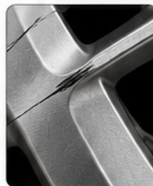
Próbka D — Powierzchnia z uszkodzeniem kontrolnym
